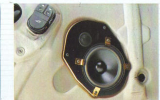
Montagerahmen MR 3 mit L 403-T und L 401-W als Türlautsprecher im Ford Mondeo.
