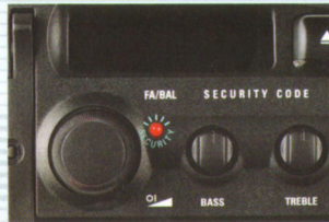
Die Blink-LED bei ausgeschaltetem Gerät zeigt ungebeten Interessenten an: Autoradio kodiert.
