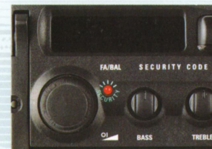
Die Blink-LED bei ausgeschaltetem Gerät zeigt ungebetenen Interessenten an: Autoradio kodiert.
