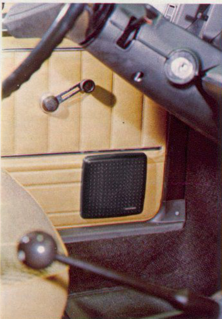
Einbaulautsprecher L/U 21 Nennbelastbarkeit 5 W Musikbelastbarkeit 7 W Übertragungsbereich 80... 12500 Hz Grill – ca. 142 × 142 × 18 mm; zusätzlich 37 mm für Einbautiefe erforderlich.
