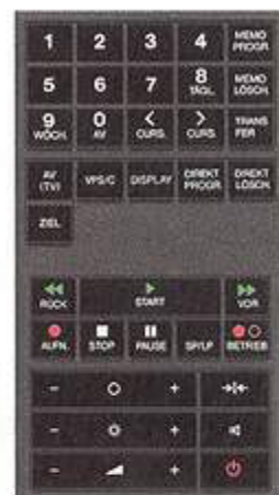
Kombi-Fernsteuerung für Videorecorder und SABA TV-Geräte. Mit LCD-Display zum geräteunabhängigen Vorprogrammieren der Aufzeichnungen.
