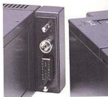
Kabellose Steckverbindung – der sichere Schnellkontakt zwischen PVR 6083 und VTU 683.
