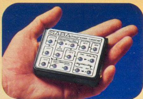
Der SABA diagnose-tester ist ein kleines Meßgerät, das dem Service-Techniker ein blitzschnelles Auffinden der meisten Fehlerursachen ermöglicht. Der diagnose-tester zeigt durch Leuchtdioden sofort und eindeutig die Diagnose an. Als zusätzliche Unterstützung bietet SABA dem Service-Techniker zwei weitere Diagnose-Stufen:
