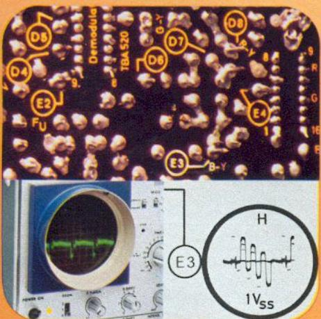
Die SABA 3-Stufen-Diagnose in Verbindung mit den steckbaren Funktionsmoduln ist ein verbraucherfreundliches Instrument, um einen schnellen und problemlosen Service von hoher Qualität zu garantieren.
