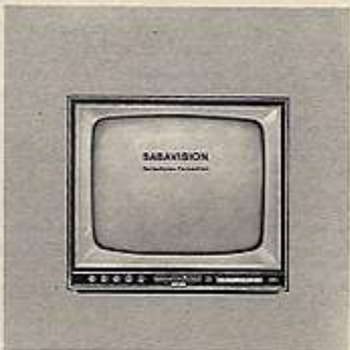
SABA Schauinsland T 145 Automatic Ein modernes Gerät der SABA Automatic-Serie. Vier Schnellwahl-Drucktasten im VHF-Bereich bewirken eine blitzschnelle Umschaltung von Programm zu Programm. Auch die Umschaltung VHF/UHF erfolgt durch Tastendruck. Weitere Vorzüge: SABAVISION — Zeilenfreies Fernsehen, fernsteuerbare Tele-Lupe zur Bildvergrößerung, fotozellengesteuerte Kontrastautomatik.
