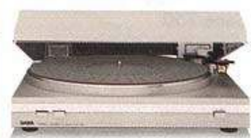
SABA HiFi-Plattenspieler CSP 358 Passend zur HiFi-Serie 355. Halbautomatischer Plattenspieler mit Riemenantrieb (belt drive) und Rückführung des Tonarms bei Unterbrechung während des Abspielens. Geschwindigkeit über Tasten bei geschlossener Haube wählbar. Low-mass-Tonarm mit hydraulischem Tonarmlift. Antiskating-Einrichtung, schwerer Druckfuß-Plattenteller, Abtastsystem Audio Technica AT 71 D. Ausführung: neusilber. Maße: 35 x 11 x 35 cm (B x H x T).
