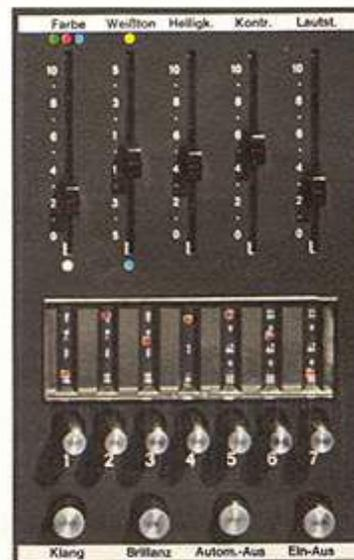
Das Gerät besitzt 5 Flachbahnregler zur stufenlosen und exakten Regelung von Farbsättigung, Weißton, Helligkeit, Kontrast und Lautstärke. Der Farbregler ermöglicht die Einstellung aller Farbsättigungsgrade vom reinen Schwarzweißbild über hauchzarte Pastelltöne bis zum „knallbunten“ Farbbild.
