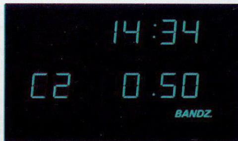
Das ATTS-System (ATTS = AUTO-TAPE-TIME-SELECT) erkennt **automatisch** die **Gesamtspielzeit**, sowie die bereits **abgelaufene Spielzeit** von **normgerechten Stunden-Cassetten** und zeigt diese im Anzeigefeld des Recorders an. Auf der Ziffern-Digital-Anzeige kann man auch den Cassettyp und die abgelaufene Bandspielzeit ablesen. Der Benutzer ist also stets im Bilde, ob die Bandkapazität für eine weitere Aufzeichnung ausreicht.
