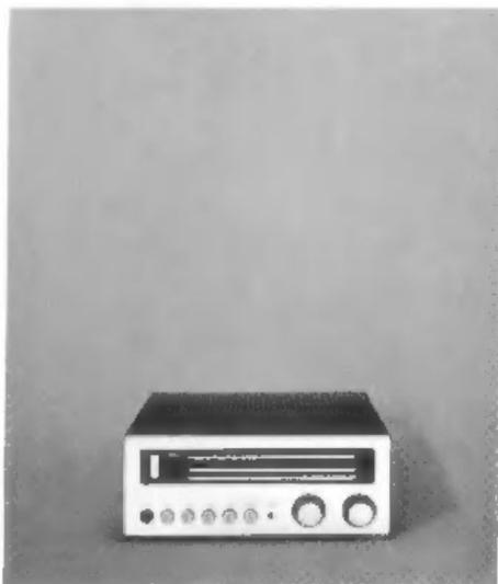
Neues, volltransistorisiertes, hochwertiges Rundfunkempfangsteil. Große Reichweite, hohe Trennschärfe. Empfang von M, L, UKW, UKW-Stereo. Ausführung CE 500 K wahlweise statt mit Langwelle mit Kurzwelle (K) ausgerüstet. Abschaltbare automatische Scharfabstimmung «afc», 18 Transistoren, 20 Dioden. 12 UKW-Kreise. Klirrfaktor 0,5% bei 1000 Hz, Empfindlichkeit auf UKW 1,2  $\mu$ V für 30 dB Rauschabstand bei 40 kHz Hub. Gehäuse Stahlblech mit anthrazitgrauem Kräusellack, Frontplatte Aluminium.
