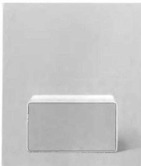
Wurde als hochwertige, klangstarke Einheit vor allem für Stereo-Geräte wie z. B. audio 2, CSV 250 entwickelt. Extrem weiche Aufhängung der Membrane. Übertragungsbereich von 30 Hz bis über die obere Hörgrenze. Belastbarkeit 30 Watt nach DIN. Impedanz 4 Ohm. Bestückung: 1 Tieftonlautsprecher, 1 Hochtonlautsprecher (Kalottenmembran). Gehäuse: Holz mit weißer Kunststoffoberfläche oder Nußbaumfurnier. Frontseite eloxiertes Alu-Geflecht. Maße: 56 x 24,5 x 22 cm (b x h x t). Preis auf Anfrage.
