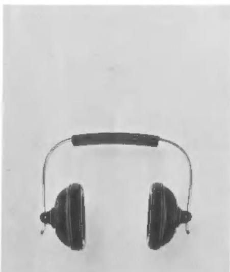
Ungestörtes Musikhören in echter HiFi-Qualität ermöglichen die neuen Kopfhörer KH 1000. Sie besitzen besonders leichte Bügel und gut abgedichtete, große Ohrmuscheln. An einen HiFi Verstärker, z. B. CSV 1000 angeschlossen, können alle Tonfrequenzquellen, Plattenspieler, Tonbandgerät oder Tuner abgehört werden. Empfindlichkeit: 0,075 mW/ $\mu$  bar, Klirrfaktor: kleiner als 0,3% bei 120 Phon, Übertragungsbereich: 16 ... 20 000 Hz, Impedanz: 400 Ohm; max. Dauerlast: 400 mW. DM 180,—.
