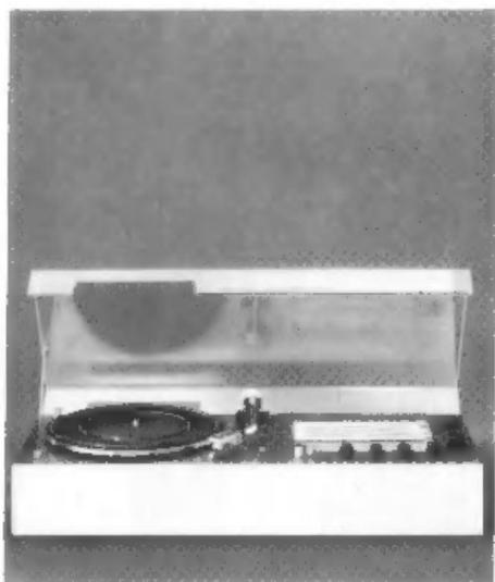
Ausgerüstet mit Plattenspieler P 410, Radioempfangsteil, Verstärker. Flach gebaut, volltransistorisiert. Echte HiFi-Wiedergabe. 2 x 15 Watt Sinusleistung (2 x 25 Watt Musikleistung). Übertragungsbereich 30... 30 000 Hz. Klirrfaktor kleiner als 0,5% (bei 2 x 12 Watt). Radioempfangsteil für U, K, M, L.
