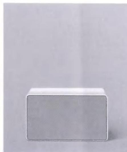
Wurde als hochwertige, klangstarke Einheit vor allem für Stereo-Geräte wie z.B. audio 250, CSV 250 entwickelt. Extrem weiche Aufhängung der Membrane. Übertragungsbereich von 30... 25 000 Hz, Belastbarkeit 30 Watt, Impedanz 4 Ohm. Bestückung: 1 dynamischer Tiefton-, 1 dynamischer Hochtonlautsprecher (Kalottenmembran). Gehäuse: Holz mit weißer Kunststoffoberfläche oder Nußbaumfurnier. Frontseite eloxiertes Alu-Geflecht. Maße: 45×25×22 cm (b×h×t). DM 460,—
