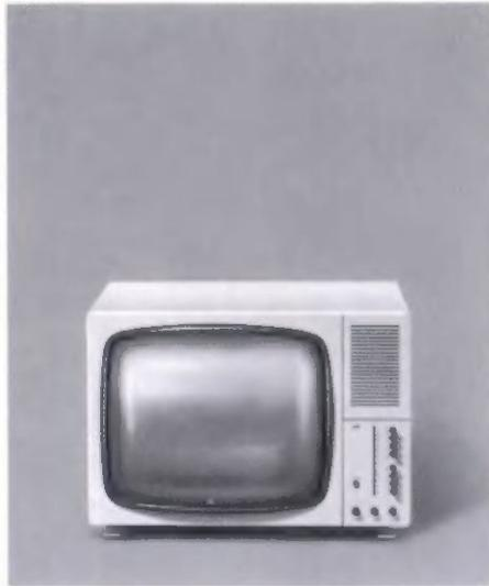
Mit implosionssicherer Bildröhre, 59 cm, und großem Frontlautsprecher. Zeilenfang, Bildfang usw. werden automatisch geregelt, nur Helligkeit und Lautstärke müssen manuell eingestellt werden. Drucktastentuner für alle Programme. Bestückung: 12 Röhren, 6 Transistoren, 10 Dioden, 1 Gleichrichter. Empfangsbereiche Band I, III, IV, V. Anschlüsse für Außenlautsprecher und Fernbedienung (Helligkeit und Lautstärke). Gehäuse: Holz, nußbaumfarben und Frontplatte graphit.
