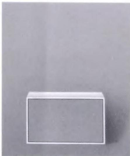
Weiter entwickelt wurde die bekannte L 450 mit neuem, dynamischen Hochtonlautsprecher (Kalottenmembran). Übertragungsbereich 33... 25 000 Hz, Belastbarkeit 25 W, Impedanz 4 Ohm. Bestückung: 1 dynamischer Tiefton-, 1 dynamischer Hochtonlautsprecher. Gehäuse: Holz mit weißer oder graphitfarbener Kunststoffoberfläche oder Nußbaumfurnier. Frontseite eloxiertes Alu-Geflecht. Maße: 47×28×10,5 cm (b×h×t). DM 320,—
