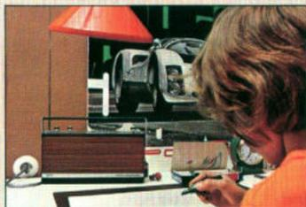
ist im 49-m-Band gespreizt. Dies erleichtert das exakte Einstellen und hilft gleichzeitig, die gängigen Kurzwellensender schneller zu finden. Die Feinabstimmung im UKW-Bereich erfolgt über eine automatische UKW-Scharfabstimmung. Auch als Tonverstärker kann der Page netzautomatic eingesetzt
