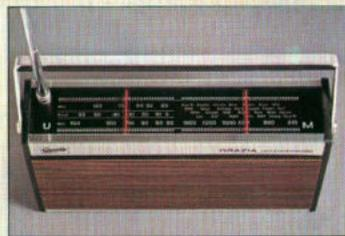
Sie können die Grazia netzautomatic also auch batteriesparend an die Steckdose anschließen. Die Batterien schalten sich dann automatisch ab. Ein Anschluß für Ohrhörer oder Außenlautsprecher ist ebenfalls vorhanden. (Technische Daten siehe Seiten 34/35)
