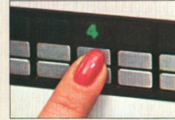
Technisch gesehen bietet der Gouverneur weit mehr als Standard: Die vollelektronische Programmwahl ohne mechanische Tasten oder Schalter. Zum Umschalten der Programme genügt der Hauch einer Berührung. Helligkeit, Kontrast, Klang und Lautstärke lassen sich leicht und stufenlos über Schieberegler einstellen. Auch eine Fernbedienung kann angeschlossen werden. Über sie lassen sich Programmwahl, Helligkeit und Lautstärke steuern. Viele Automatik-Funktionen sorgen für ein gleichbleibend gutes Bild.
