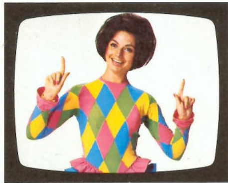
Farbstärkereger in Mittelstellung: richtige Farbsättigung
