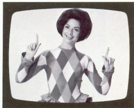
Farbtonregler nach rechts gedreht: bläuliches Schwarzweiß-Bild (oder Farbbild)
