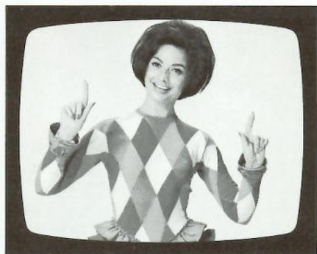
Farbtonregler in Raststellung: neutrales Schwarzweiß-Bild (oder Farbbild)
