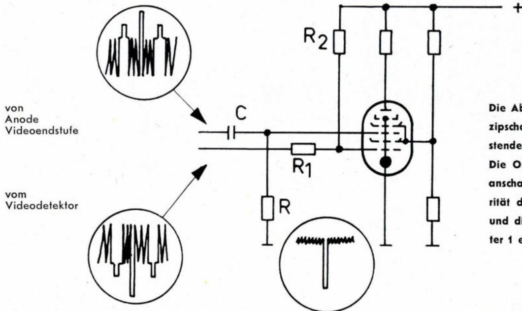
Die Abbildung zeigt die Prinzipschaltung des störaustastenden Amplitudensiebes. Die Oszillogramme lassen in anschaulicher Weise die Polarität der angelegten Signale und die Begrenzung am Gitter 1 erkennen.
