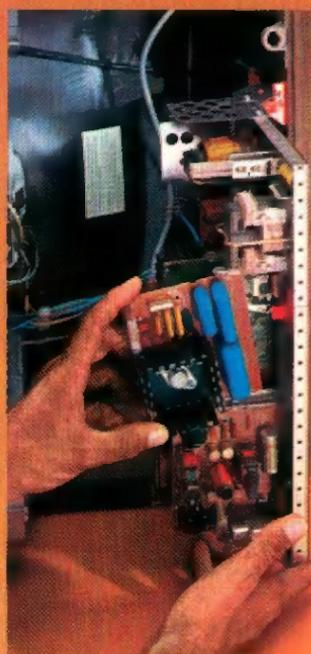
Blaupunkt hat mit dem Einsatz fortschrittlicher Raumfahrt- und Computer-Technologie eine Miniaturisierung der Bauteile erreicht. Damit war es möglich, alle Funktionen auf steckbaren Moduln organisch zusammenzufassen. Die Funktionsmoduln werden erstmalig bei Blaupunkt mit Computern unter „echten“ Betriebsbedingungen geprüft. Dadurch können selbst kleinste Fehler sofort gefunden werden.
