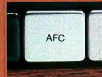
Die AFC-Taste zur **automatischen Scharfabstimmung von Bild und Ton**
