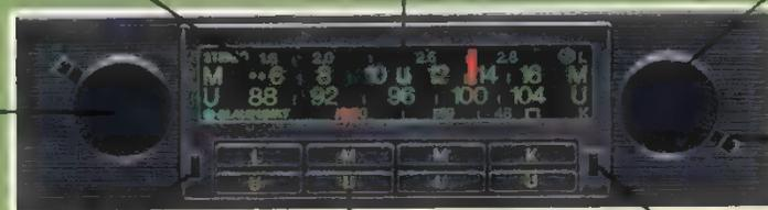
Schalter zur Vorbelegung des Tastensatzes. Stellung unten = UKW, Stellung oben = K, M, L.
