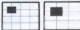
PiP (Bild-im-Bild): ein TV-Programm sehen und gleichzeitig ein anderes kontrollieren. In 1/4 oder 1/16 des normalen Bildformats.
