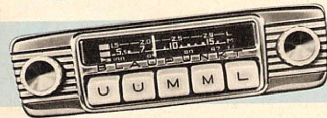
**FRANKFURT** • Autosuper für Langwellen-, Mittelwellen- und UKW-Empfang – Radiodetektor mit Vorbegrenzer sichert stabilen UKW-Empfang – Hochfrequenz-Vorstufen für AM und FM, 6 Röhren, 1 Trockengleichrichter, 2 Kristalldioden – 14 (6) Funktionen – 6+1/12 Kreise – ca. 3 W Ausgangsleistung.
