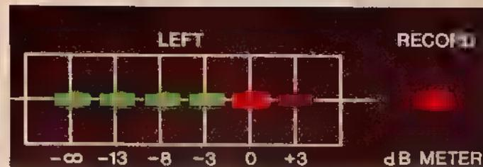
2-Kanal-Aussteuerungsanzeige. Für die klangrichtige Anpassung der Aufnahme an die akustischen Bedingungen können Sie jeden Kanal einzeln aussteuern — und auf der LED-Anzeige alles genau kontrollieren. Weitere Ausstattung für perfekten Klang: Dolby-NR<sup>®</sup>-System.
