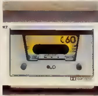
Auch das gehört zur perfekten Ausstattung: Die gedämpft öffnende Cassettenklappe ist abnehmbar, damit Sie den Tonkopf leicht reinigen können.
