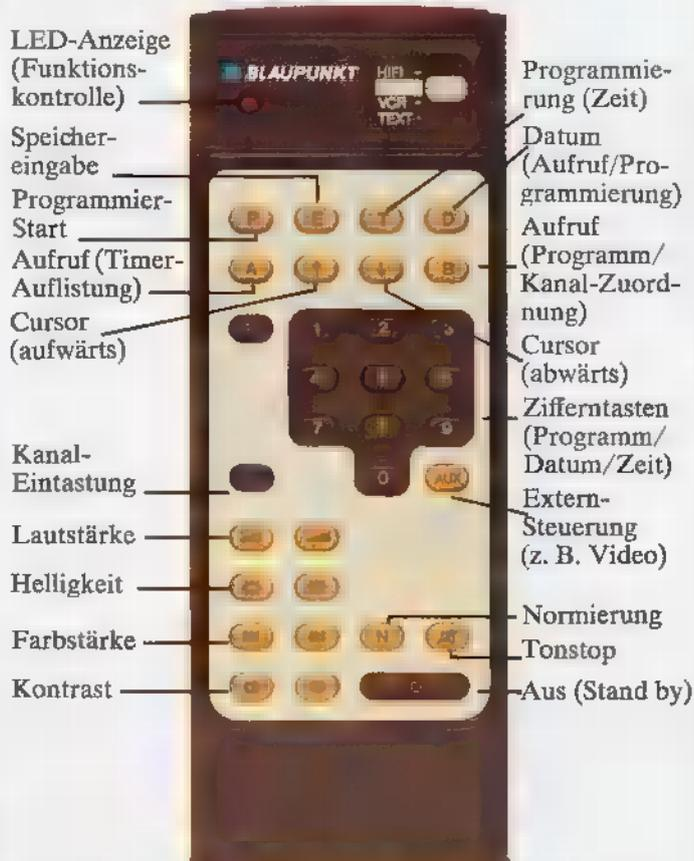
Der Infrarot-Fernprogrammierer. Eines der Steuerzentren des Systems Blaupunkt PK 100 S. Komfort-Elektronik macht Farbfernsehen noch attraktiver, und die durchdachte Anordnung aller Steuertasten macht diese Leistung leicht beherrschbar.
