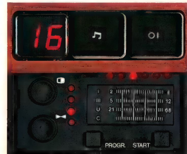
Viel Bedienungskomfort durch digitale Programmspeicherung und Sendersuchlauf.
