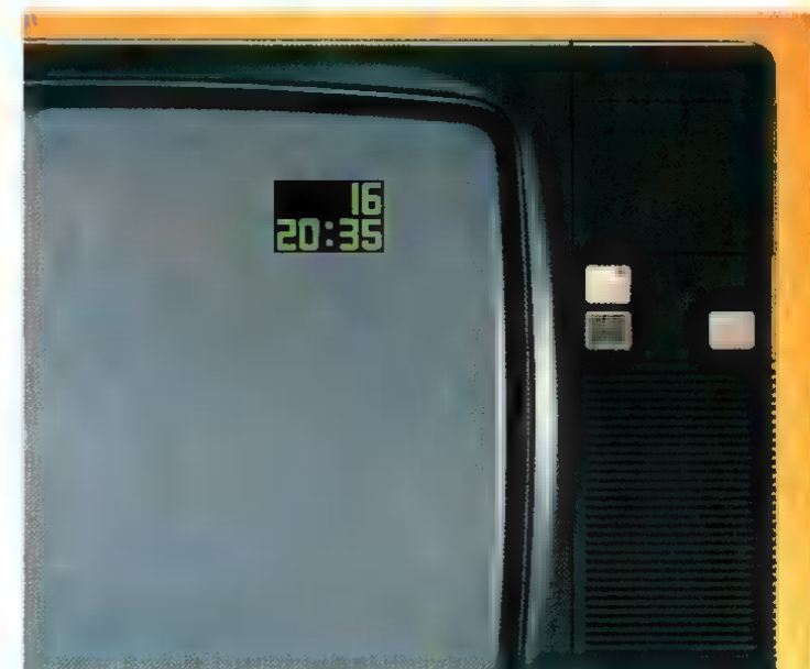
Perfekt bis ins Detail: Programm- und Zeitanzeige. Beim Einschalten und bei jedem Programmwechsel für Sekunden eingblendet.
