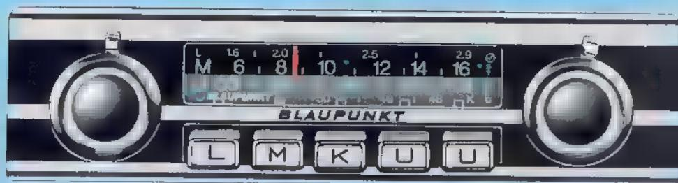
Stereo-Autoradio für Empfang und Wiedergabe von Stereo-Rundfunk-sendungen. Automatische Mono-Stereo-Umschaltung. Optische Stereo-Anzeige. Eingebauter Stereo-Balance-Regler. Senderschnellwahl durch 5 Stationsdrucktasten. Automatische UKW-Scharfabstimmung durch ETC. Zusätzlicher Mono-Schalter. Je nach Wagentyp können (in Verbindung mit dem Überblend-regler) bis zu 4 Lautsprecher ange-schlossen werden.
