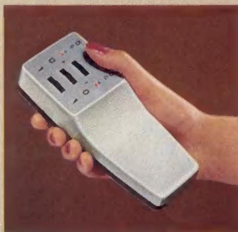
Programmanzeige. Verdeckt angeordnet die Regelmöglichkeiten für alle Abstimm- und Bedienfunktionen.
