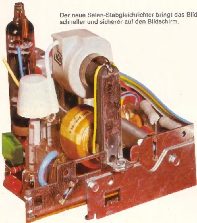
Der neue Selen-Stabgleichrichter bringt das Bild schneller und sicherer auf den Bildschirm.
