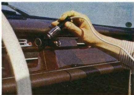
Auto-Batterie-Anschluß durch Adapter für Zigarettenanzünder.
