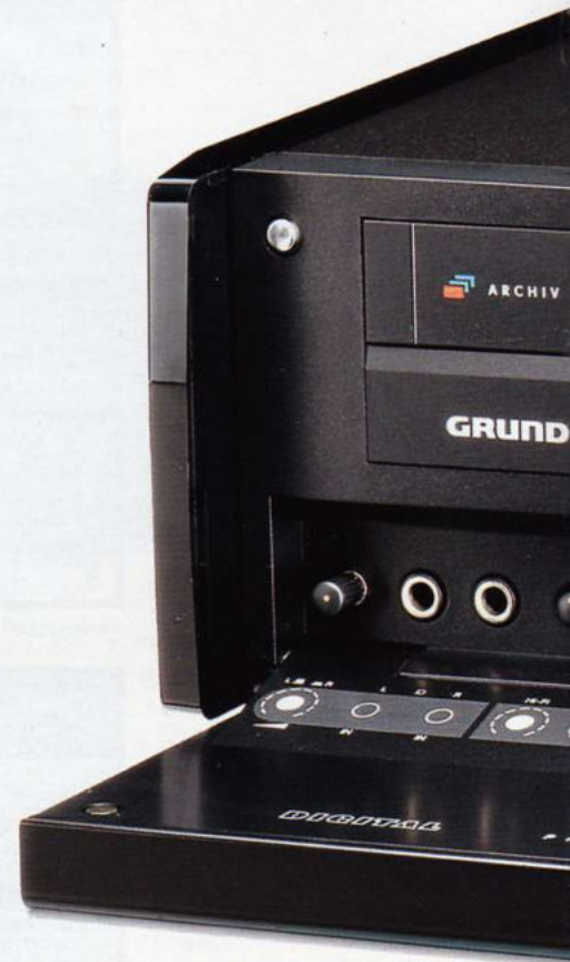
Jog-Shuttle zum schnellen Wiederfinden gewünschter Bandstellen.
