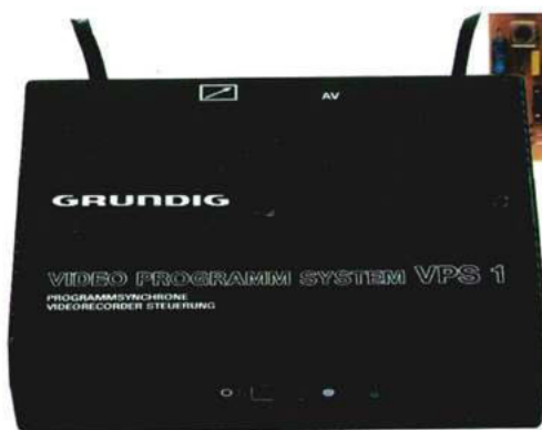
VPS-Decoder 300 für Grundig VHS-Recorder der 300er Serie, die noch nicht komplett für VPS ausgerüstet sind.
