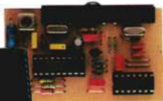
VPS-Decoder 300 für Grundig VHS-Recorder der 300er Serie, die noch nicht komplett für VPS ausgerüstet sind.
