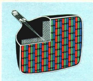
Heller, schärfer: die neue inline-Schlitzmasken-Farbbildröhre (Schlitze in der Abbildung stark vergrößert).
