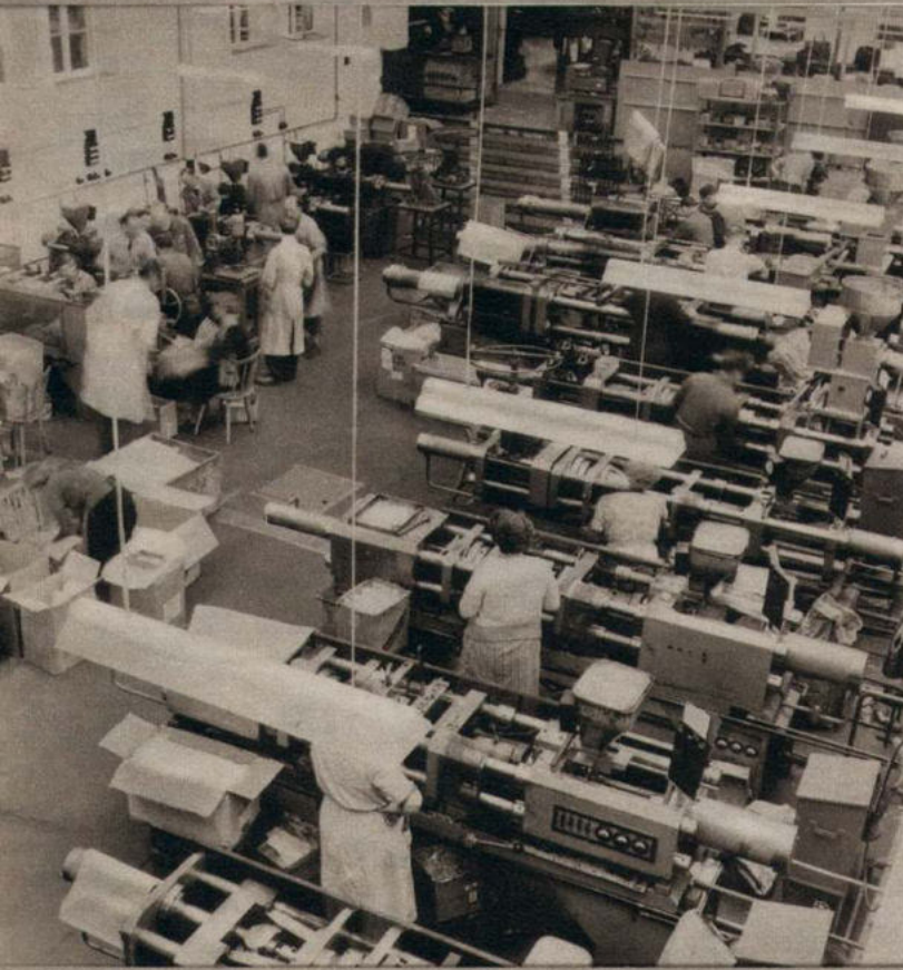
Europas größte Anlage zur Verarbeitung modernster Kunststoffe befindet sich in den GRUNDIG-Werken in Fürth. Hier entstehen Drucktasten, Spulenträger, Gehäuse und viele andere Bauteile für Rundfunk-, Fernseh- und Tonbandgeräte. Photos: Carlsen (5), Artler (1).
