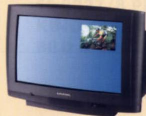
**BILD-IM-BILD-DARSTELLUNG (PIP)** Stört es Sie, beim Zappen durch die Programme den Anpfiff vom Fußballspiel zu verpassen? Das sollten Sie ändern. Mit der PIP-Funktion können Sie ein Kleinbild von einer externen Signalquelle (1-Tuner-PIP) oder auch ein anders terrestrisches TV-Programm in den Bildschirm einblenden (2-Tuner-PIP). So zappen Sie großformatig durch die Sender, können aber auf dem Kleinbild ganz genau den Spielfeld beobachtet.
