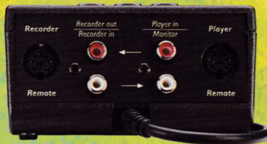
Rückseite der Video-Mouse: Buchsen zum Anschluß der Steuerleitung für Player und Recorder, sowie Video-Ein- und Ausgänge.
