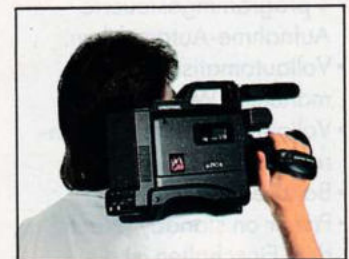
Die integrierte Schulterstütze ermöglicht eine bequeme Handhabung dieses großformatigen Camera-Recorders.
