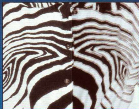
Wirkung der Elektronenstrahl-Geschwindigkeits-Modulation (linke Hälfte).
