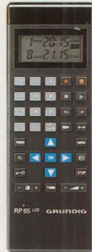
VS 505 VPS mit Fernbedienung RP 65 LCD.
