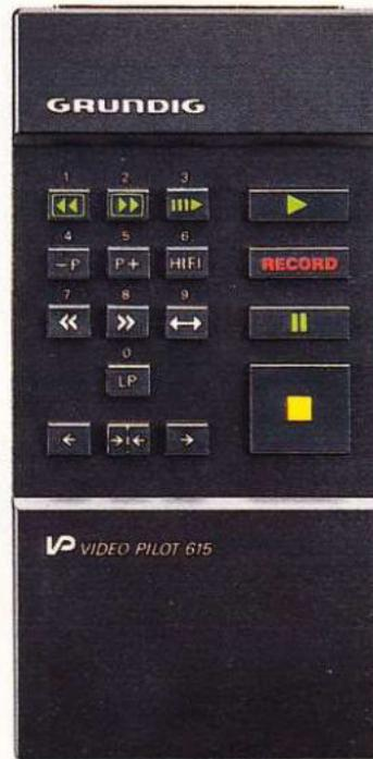
Die Infrarot-Fernbedienung für alle Lauffunktionen gehört zum Lieferumfang des VS 400.
