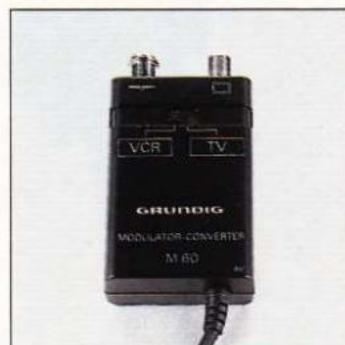
**Modulator M 60 für Camera-Recorder VS-C 60**
