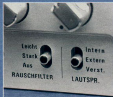
Die Lautsprecher-Umschaltung gehört genauso zur Bedienungsfreundlichkeit wie das abschaltbare Rauschfilter
