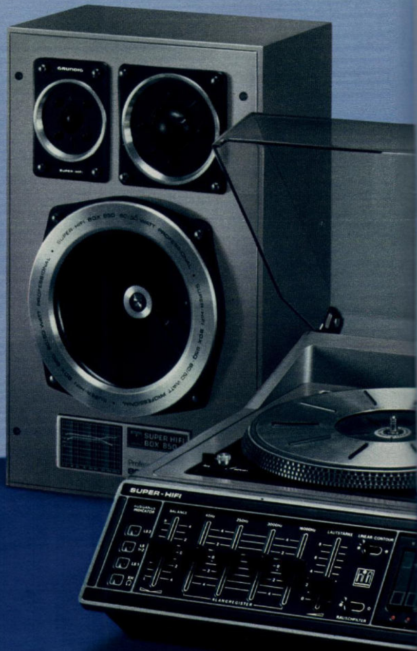
Abbildung unten links: 4-fach Klangregister zum individuellen Einstellen von Bässen (40 Hz), Tiefen (250 Hz), Präsenz (3 kHz) und Höhen (16 kHz)
