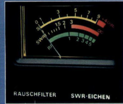
Anzeige-Instrument für relative Feldstärke, HF-Ausgangsleistung und Stehwellenverhältnis
