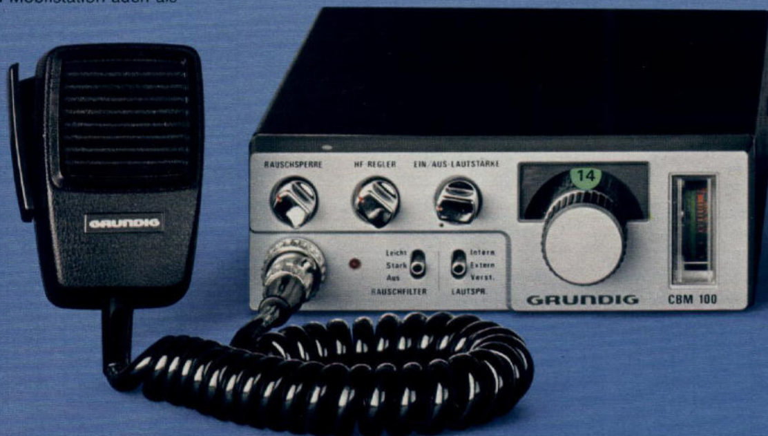
Die Lautsprecher-Umschaltung gehört genauso zur Bedienungsfreundlichkeit wie das abschaltbare Rauschfilter
