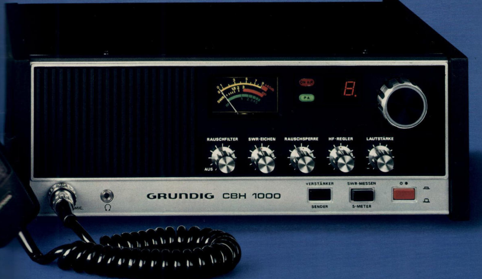
Anzeige-Instrument für relative Feldstärke, HF-Ausgangsleistung und Stehwellenverhältnis
