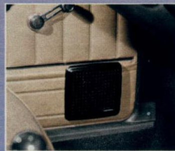
Einbaulautsprecher L/U 21 Grill = ca. 142 x 142 x 18 mm; zusätzlich 37 mm für Einbautiefe erforderlich.
