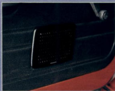
Einbaulautsprecher L/U 19 Grill = ca. 165 x 110 x 15 mm; zusätzlich 46 mm für Einbautiefe erforderlich.
