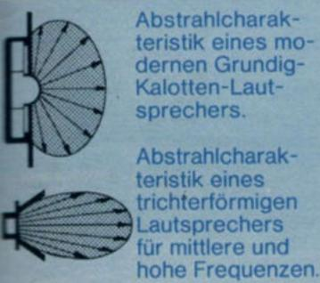
Abstrahlcharakteristik eines modernen Grundig-Kalotten-Lautsprechers.
