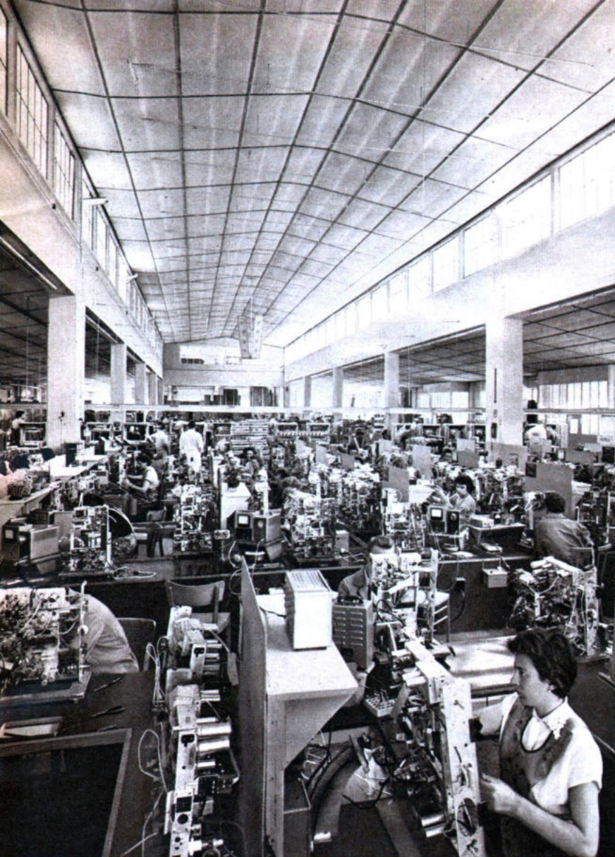
▲ 60 einzelne Prüfvorschriften sorgen auf 60 Prüfstationen bei Fernsehempfängern für die berühmte GRUNDIG Präzision in Bild und Ton.
