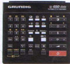
Der Tele-Pilot 650 data ist jetzt „international“: durch übersichtliche Beschriftung und leicht verständliche Symbole. Dabei bleibt er elektrisch vollkommen identisch mit dem Tele-Pilot 650. Um bei NTSC-Empfang den Komfort der IR-Fernbedienung voll zu nutzen, wurde die Taste „TINT“ in den TP 650 data integriert.
