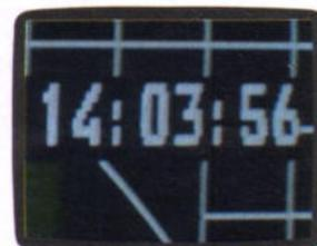
Die Uhrzeit in Stunden, Minuten und Sekunden läßt sich digital rechts oben ins laufende Programm einblenden.
