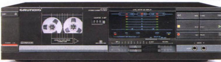
2-Motoren-Deck mit elektronischer Laufwerksteuerung. Die Bandsorten-Einstellung erfolgt automatisch beim Einlegen der Cassette. Die automatische Azimuth-Korrektur (AZTEC®) sorgt für die wichtige Senkrechstellung des Kopfes, damit einmal aufgenommene Bänder auch über jedes andere Cassettendeck gut klingen.
