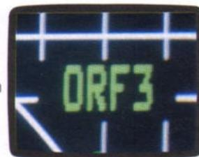
Die Senderkennung (Program Code) läßt sich durch 4 programmierbare Buchstaben bzw. Ziffern als Kurzbezeichnung ins Bild einblenden.
