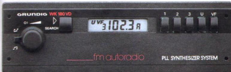
Autoradio mit PLL-Frequenz-Synthesizer-Abstimmung, Sendersuchlauf, LC-Display und Verkehrsfunk-Decoder für SDBK.
