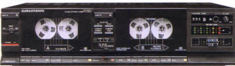
Vollelektronische Laufwerksteuerung. Reverse-Laufwerk bei Deck B. Aufnahme- und Wiedergabekopf werden bei Laufrichtungsänderung um ihre Achse gewendet, wodurch Azimuthfehler vermieden werden. Endlosbetrieb über 3 Cassettenseiten möglich. Weitere Features: Regelbarer Kopfhörerausgang, MPX-Filter und Fernbedienmöglichkeit.
