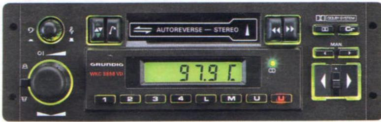
Das testbewährte Autoradio mit microprozessor-gesteuertem PLL-Frequenz-Synthesizer, digitaler LCD-Frequenzanzeige, Sendersuchlauf, Verkehrsfunk-Decoder für SDBK, Autoreverse und Dolby\*-NR-System.
