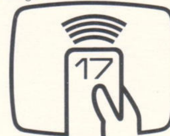
Fernbedienung mit 17 Funkti- onen: 8 Programme, Norm- Taste, Ein/Aus, Lautstärke, Helligkeit und Farbe.
