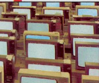
Bei NORDMENDE muß jedes Farbfernsehgerät einen 24-Stunden-Dauerlauf bestehen. Darüber hinaus werden jeden Monat 250 Geräte einem Streßtest unterzogen: Intervall-Betrieb unter extremen Temperaturen.
