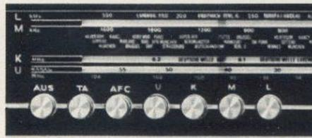
Das Stereo-Steuergerät 5001 besitzt eine automatische Mono-/Stereo-Umschaltung. Eine manuelle Umschaltung des Gerätes auf Stereobetrieb bei UKW-Stereo-Sendungen ist daher nicht mehr erforderlich. Bei Betrieb über den TA-Anschluß und bei gedrückter TA-Taste wird die Taste AFC als Mono-Taste wirksam. Das bedeutet, daß Sie beim Abspielen von Mono- oder nicht mehr einwandfreien Stereo-Schallplatten das Gerät auf Mono umstellen und damit das Klangbild verbessern können.
