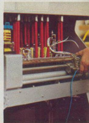
Am elektronischen Adaptermeßgerät werden vollautomatisch alle Schaltungspositionen des vollbestückten Chassis auf einwandfreie Funktion überprüft.
