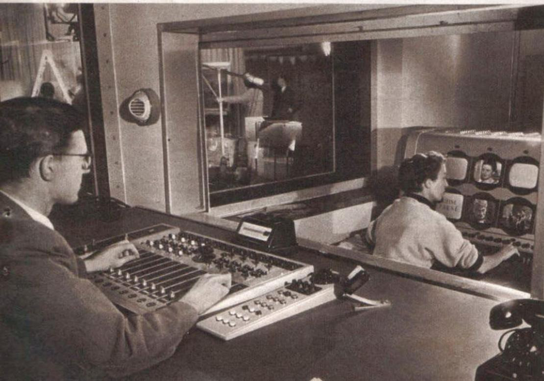
Regisseur und Bildingenieur dirigieren am Bildmischpult die Kameras und entscheiden, welches Bild über den Sender geht.
