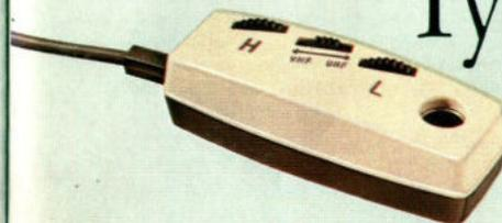
Philips Fernbedienung Typ 65 Luxus (einschl. Ohrhörer) nur passend für die Philips Fernseh-Tischgeräte Leonardo und Michelangelo, Saison 1965/66, erlaubt nach Einsetzen eines Relaiszusatzes die Programm-Umschaltung VHF/UHF und umgekehrt vom Sessel aus. Sie regelt außerdem Helligkeit und Lautstärke und besitzt eine Anschlußbuchse für einen Ohrhörer.
