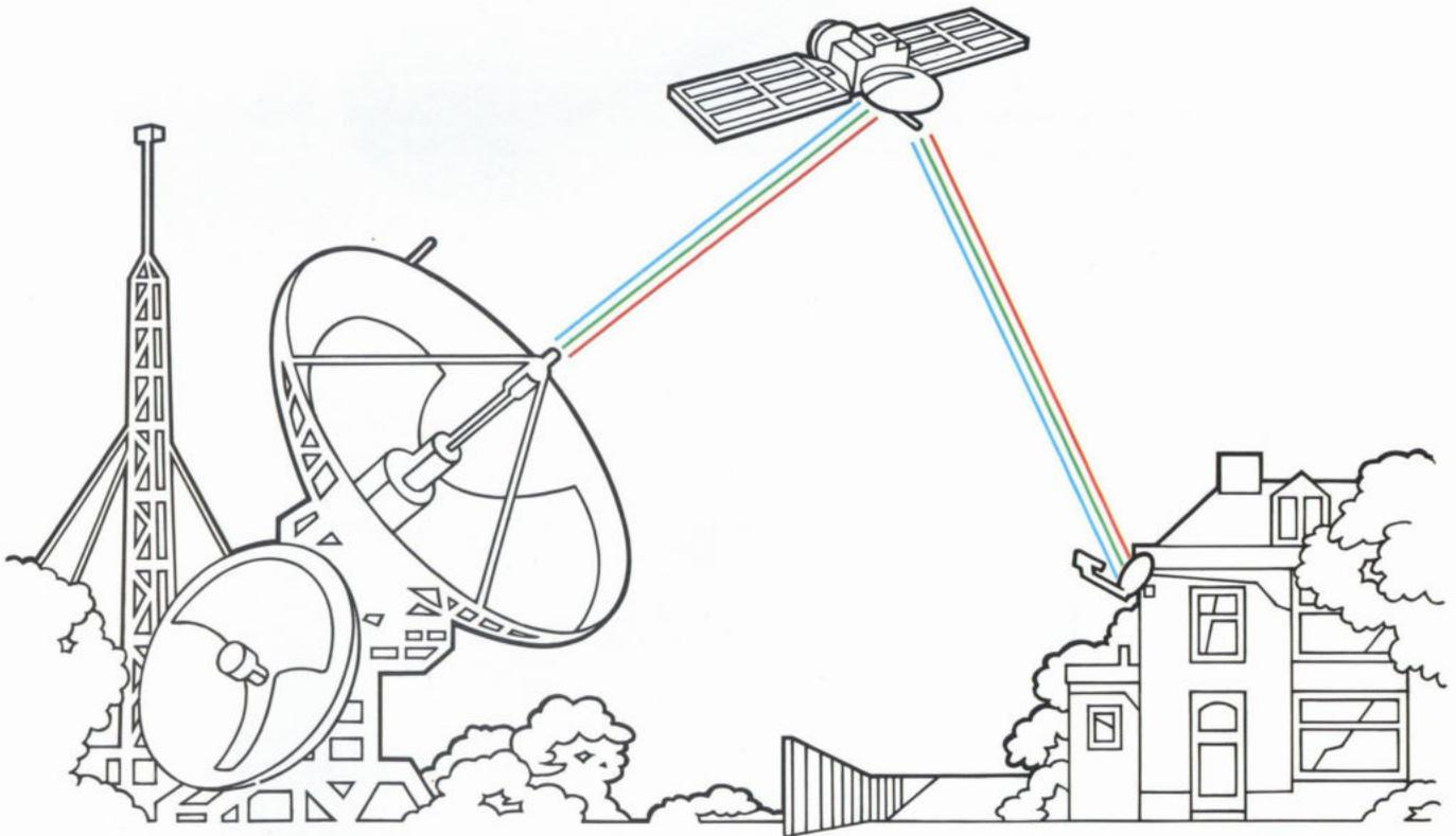
*Die Boden-Station strahlt die TV-Programme in den Weltraum. Die Signale werden von Satelliten in ca. 36.000 Kilometer Höhe mittels Antenne empfangen.*
