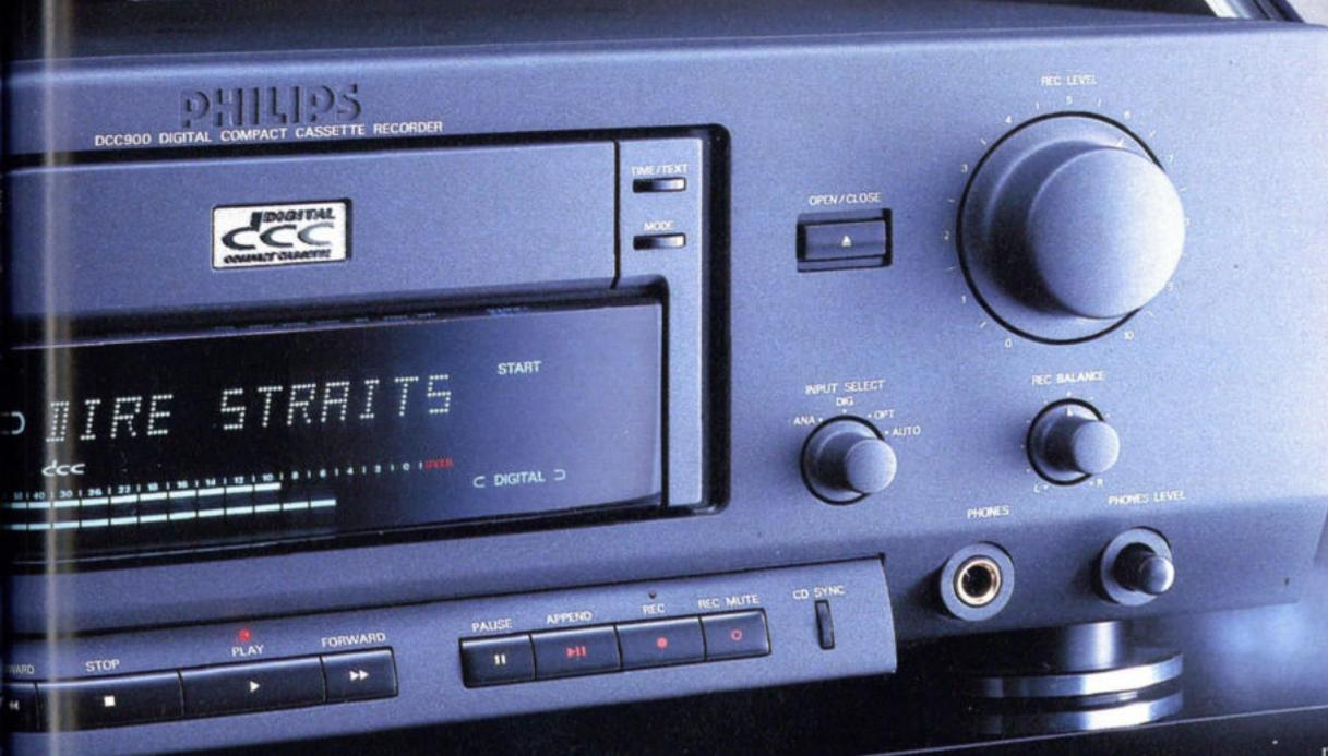
Compact-Cassetten mit Dolby B/C ■ Renumber-Funktion numeriert eine komplett selbst aufgenommene DCC, Stück für Stück ■ Next-Markierung bei der Aufnahme: DCC überspringt den Bandrest z.B. der A- oder B-Seite, auf die kein vollständiges Stück mehr paßt
