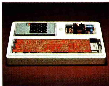
Ultraschall-Fernbedienungs-Nachrüstset Typ 75 Luxus, kann nachträglich eingebaut werden.
