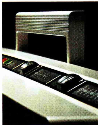
Der stabile Tragegriff ist voll versenkbar.
