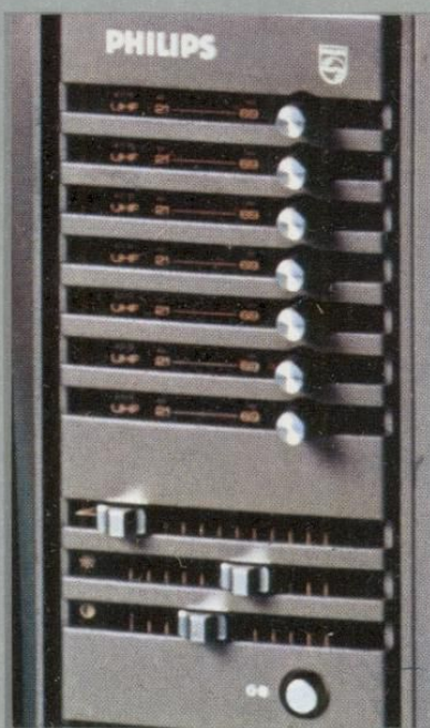
7 Stationstasten Schieberegler für Lautstärke, Helligkeit und Kontrast und Ein/Aus-Taste an der Frontseite.
