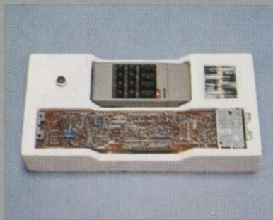
Ultraschall-Fernbedienung Typ 73 Luxus Ultraschall – das ist Fernbedienung der komfortabelsten Art: kabellos und gedankenschnell. Lautstärke, Helligkeit, Farbsättigung, direkte Programmwahl und Ton-Ein/Aus-Taste – alles bequem vom Sessel aus. Reichweite ca. 8 m.
