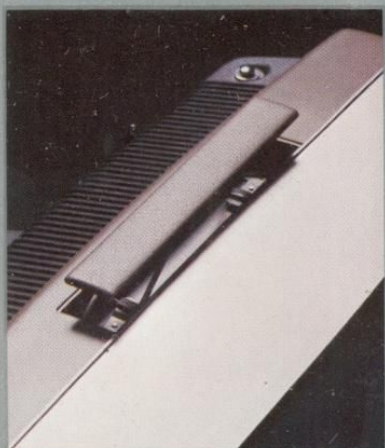
Tragegriff Der praktische Tragegriff ist wie bei allen Tragbaren von Philips voll versenkbar.
