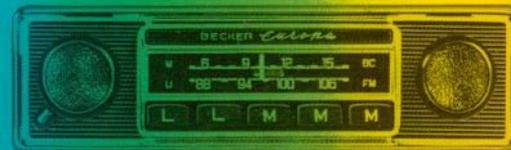
Mit diesem Gerät können 2 MW- und 3 UKW-Sender gespeichert werden. Die technische Beschreibung finden Sie auf Seite 7.
