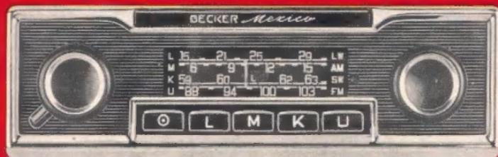
Der Becker Mexico besitzt Weltruf – ein Gerät modernster Konzeption, 4 Wellenbereiche: LW, MW, KW und UKW. Für Ihre Sicherheit: Die breite Automatiktaaste tippen Sie nur an und der gewünschte Sender wird genauer und präziser als von Hand eingestellt. Problemloser Einbau durch Einblockausführung – Flachbauweise 42 mm. Ausgangsleistung 5/7 Watt
