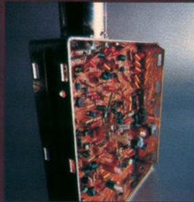
PIN-Dioden-Tuner: gleichmäßig gute Bildqualität.
