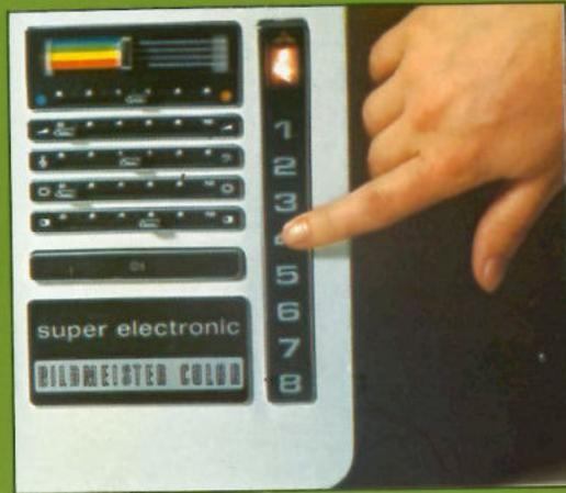
superelectronic: Vollelektronische Programmwahl und Programmanzeige durch 8 Programm-Sensoren. Blitzschnelle, geräuschlose Programmwahl durch leichtes Berühren des gewünschten Programmfeldes.
