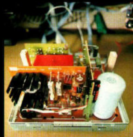
Neues Netzteil für Netztrennung und elektronische Sicherung.
