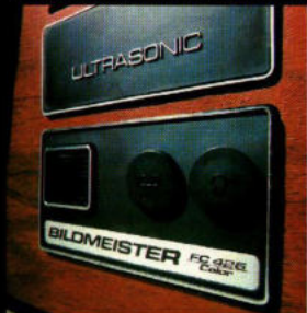
Serienmäßige Anschlüsse für Tonbandgerät oder Zusatzlautsprecher.
