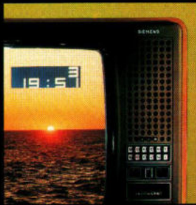
Im Bildschirm eingeblendete Uhrzeit- und Programmanzeige.
